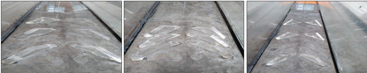
Fig. 3 Examples of the arrangement of equilateral triangle blocks in the trapezoidal channel of the present study شکل ۳ نمونه‌های از چیدمان بلوک‌های مثلث متساوی‌الساقین در کانال دوزنقه‌ای تحقیق حاضر
