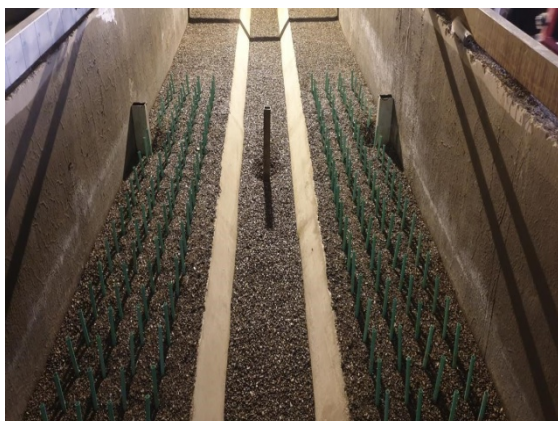
Fig. 2 Filling the bed of the main channel and floodplains with materials and 1% vegetation cover شکل ۲ پر کردن کانال و سیلاب‌دشت با مصالح و پوشش ۱٪
